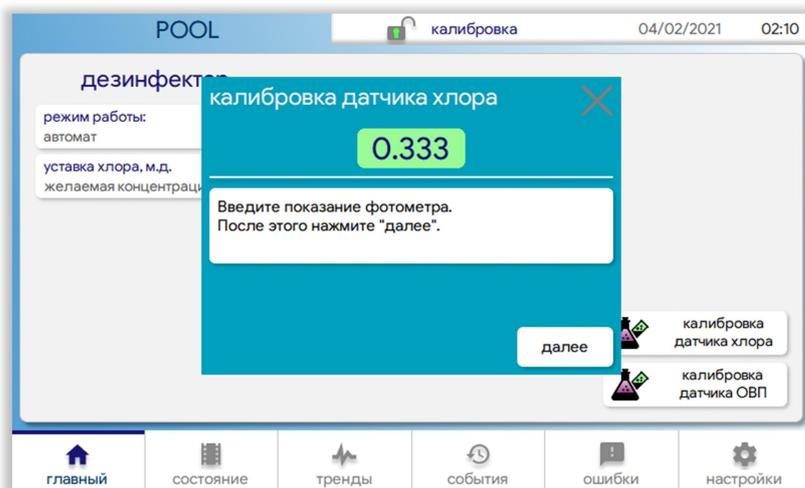
Для калибровки датчика хлора нажмите на "плитку" "калибровка датчика хлора", введите пароль и следуйте интерактивной инструкции. Калибровка датчика хлора производится по значению, измеренному с помощью фотометра.
