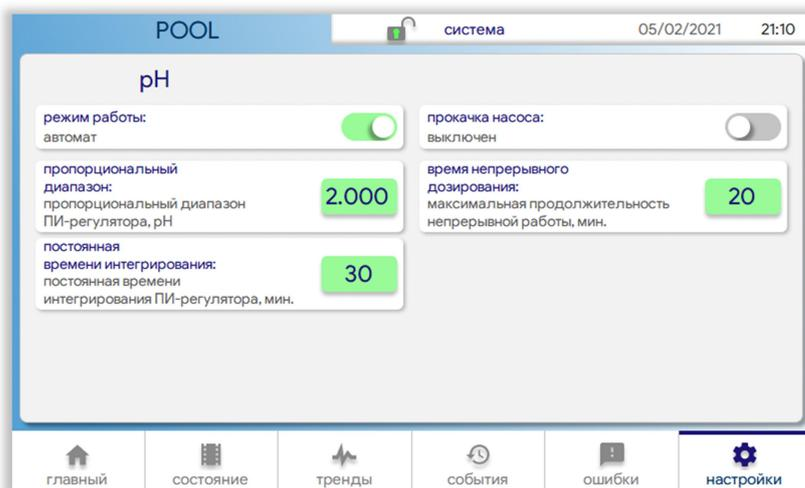
"режим работы" — выбор режима работы контура pH. В режиме "выключен" работа насоса-дозатора заблокирована. В режиме "автомат" работа насоса-дозатора осуществляется в автоматическом режиме.
