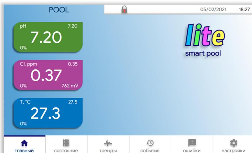
На экране в виде "плиток" отображается информация о работе трёх контуров контроля параметров воды: водородного показателя (pH), дезинфектора (Rx/Cl free\*) и температуры (Т). Переход на экран управления контуром осуществляется при нажатии на "плитку" с его названием.
