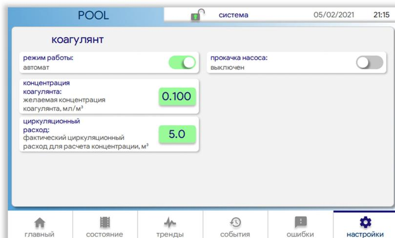
"режим работы" — выбор режима работы контура дозирования коагулянта. В режиме "выключен" работа насоса-дозатора заблокирована. В режиме "автомат" работа насоса-дозатора осуществляется в автоматическом режиме.
