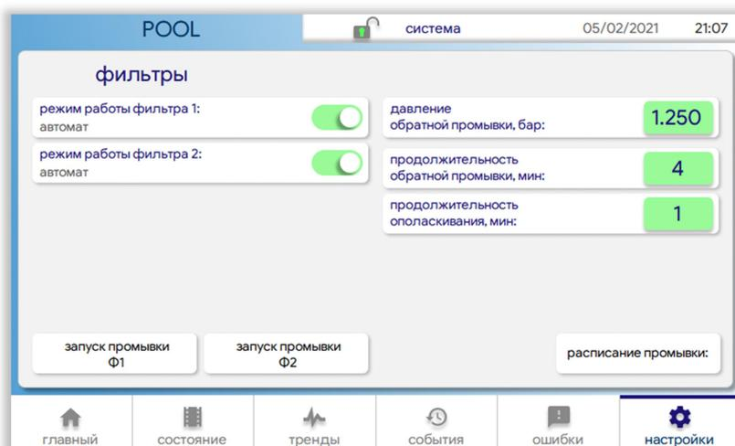
"режим работы фильтра 1/2" — выбор режима работы автоматического вентиля фильтра. В режиме "выключен" с вентиля снимается питание. В режиме "автомат" вентиль работает в автоматическом режиме.
