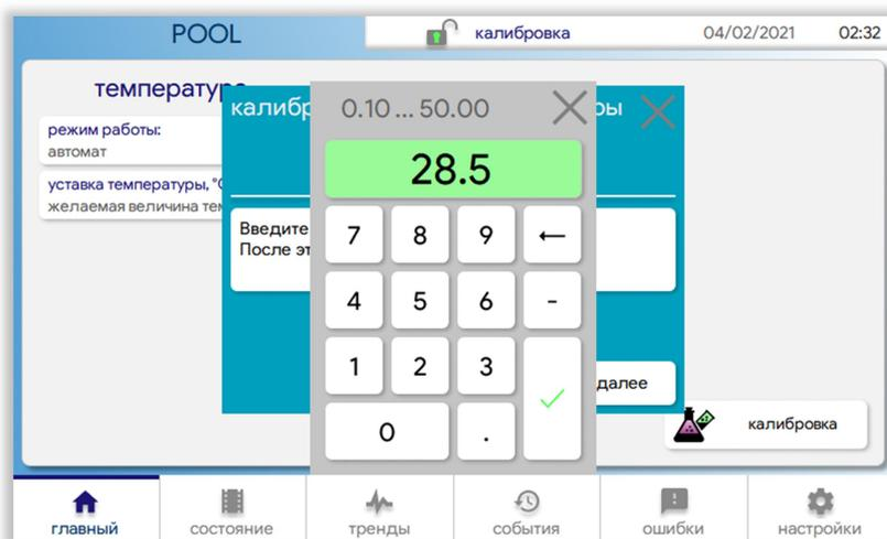
Для калибровки датчика нажмите на "плитку" "калибровка", введите пароль и следуйте интерактивной инструкции. Калибровка датчика температуры осуществляется по значению, измеренному в чаше бассейна.
