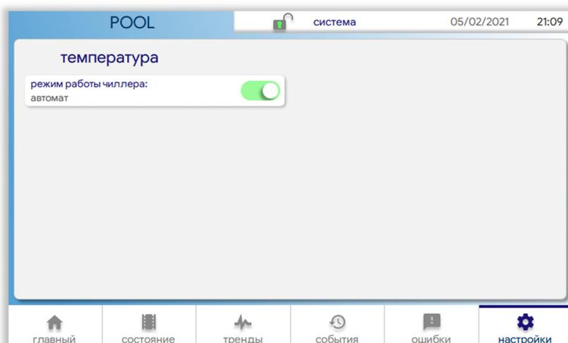
"режим работы чиллера" — выбор режима работы контура охлаждения воды. В режиме "выключен" работа чиллера заблокирована. В режиме "автомат" осуществляется автоматическое поддержание температуры воды бассейна в соответствии с уставкой.
