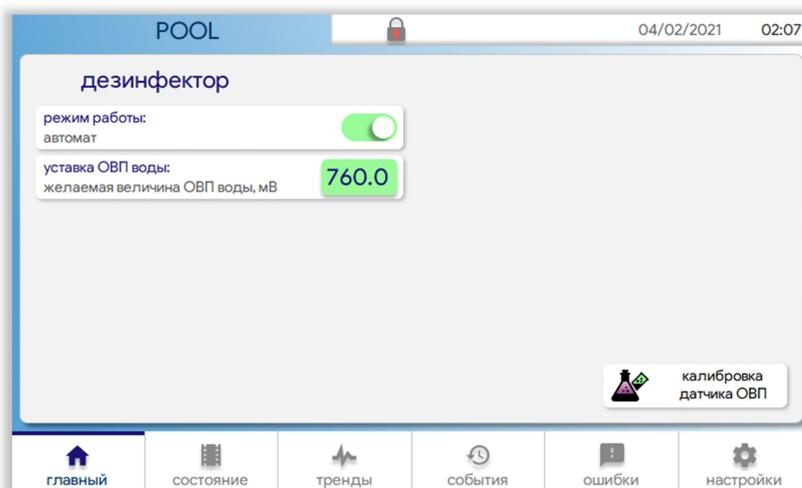
"режим работы" — выбор режима работы контура. В режиме "выключен" работа насоса-дозатора заблокирована. В режиме "автомат" контур работает в автоматическом режиме.
