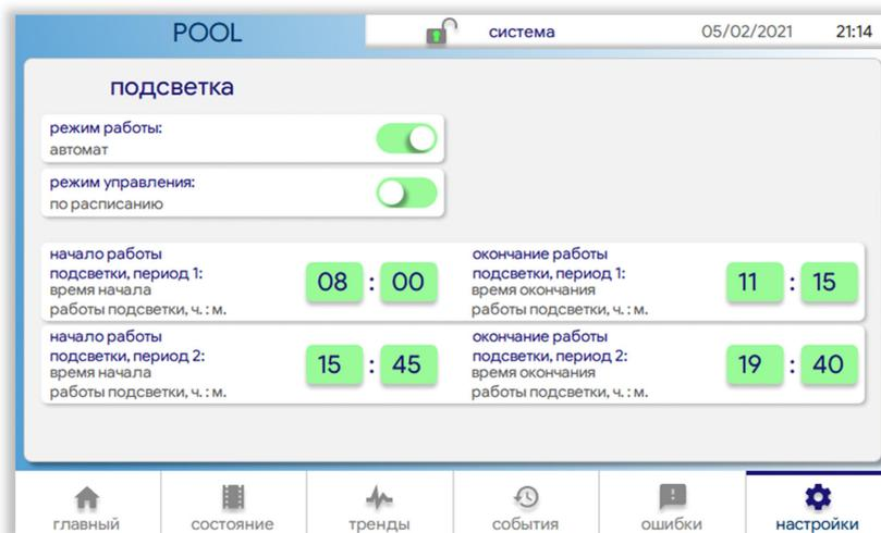
"режим работы" — выбор режима работы подсветки. В режиме "выключен" работа подсветки заблокирована. В режиме "автомат" становится доступен выбор режима управления подсветкой.
