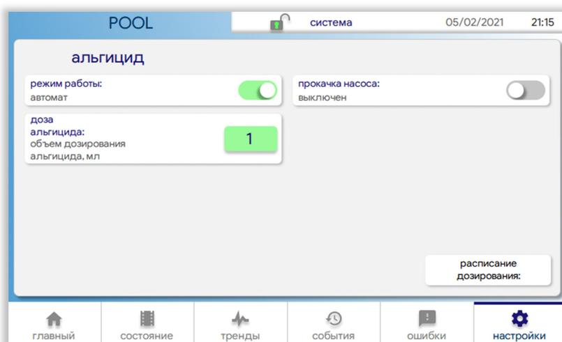
"режим работы" — выбор режима работы контура дозирования альгицида. В режиме "выключен" работа насоса-дозатора заблокирована. В режиме "автомат" работа насоса-дозатора осуществляется в автоматическом режиме.
