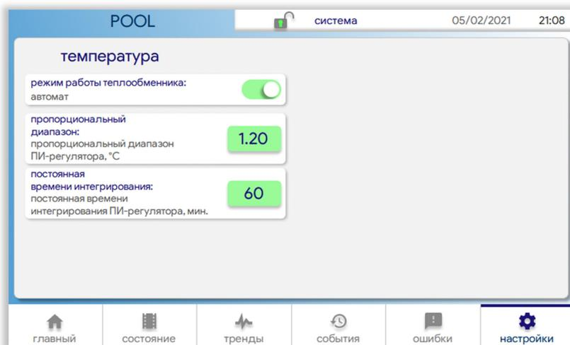
Для управления регулирующим клапаном используется ПИ-регулятор, что обеспечивает нулевую ошибку регулирования (разницу между уставкой и фактическим значением). В таком регуляторе процент открытия клапана складывается из двух составляющих — пропорциональной (П) и интегральной (И). За П-составляющую отвечает "пропорциональный диапазон", за И-составляющую — "постоянная времени интегрирования".
