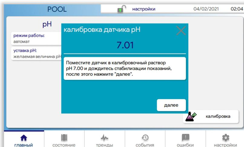
Для калибровки датчика нажмите на "плитку" "калибровка", введите пароль и следуйте интерактивной инструкцией. Калибровка датчика "pH" осуществляется по двум точкам с помощью калибровочных растворов pH 7.00 и pH 9.00.
