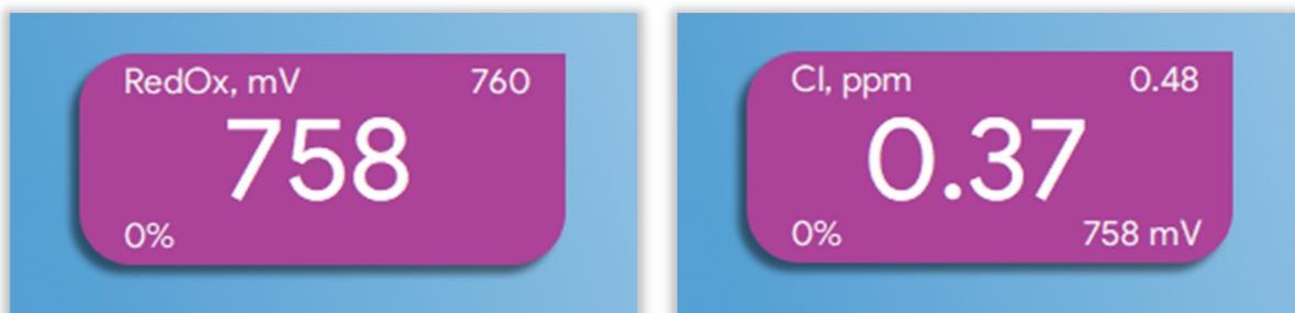
В левом верхнем углу "плитки" отображается название контура — "RedOx" или "Cl", в правом верхнем углу — уставка, в центре — фактическое значение, в левом нижнем углу — процент производительности насоса-дозатора, в правом нижнем углу — фактическое значение RedOx (при наличии датчика "Cl free"\*). При выходе фактического значения за аварийные, цвет значения становится красным.
