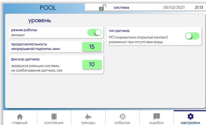
"режим работы" — выбор режима работы контура контроля уровня воды. В режиме "выключен" работа клапана подпитки заблокирована. В режиме "автомат" подпитка бассейна осуществляется автоматически по датчику уровня в переливной ёмкости или скиммере.
