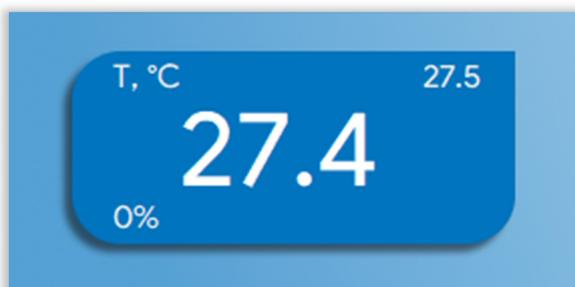
В левом верхнем углу "плитки" отображается название контура — "Т", в правом верхнем углу — уставка, в центре — фактическое значение, в левом нижнем углу — процент открытия клапана. При выходе фактического значения за аварийные, цвет значения становится красным.
