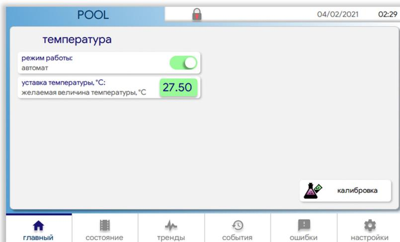
"режим работы" — выбор режима работы контура. В режиме "выключен" открытие клапана заблокировано. В режиме "автомат" контур работает в автоматическом режиме.
