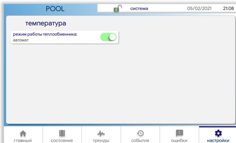
"режим работы теплообменника" — выбор режима работы контура нагрева воды. В режиме "выключен" работа теплообменника заблокирована. В режиме "автомат" осуществляется автоматическое поддержание температуры воды бассейна в соответствии с уставкой.
