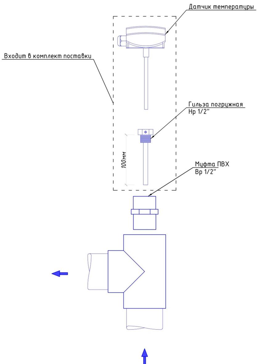
7.5 Схема №5 — Схема монтажа узла впрыска химических реагентов
