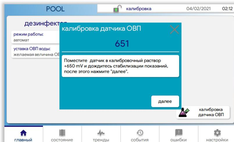
Для калибровки датчика ОВП нажмите на "плитку" "калибровка датчика ОВП", введите пароль и следуйте интерактивной инструкции. Калибровка датчика окислительно-восстановительного потенциала производится с помощью калибровочного раствора 650 мВ.
