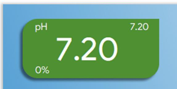
В левом верхнем углу "плитки" отображается название контура — "pH", в правом верхнем углу — уставка, в центре — фактическое значение, в левом нижнем углу — процент производительности насоса-дозатора. При выходе фактического значения за аварийные, цвет значения становится красным.
