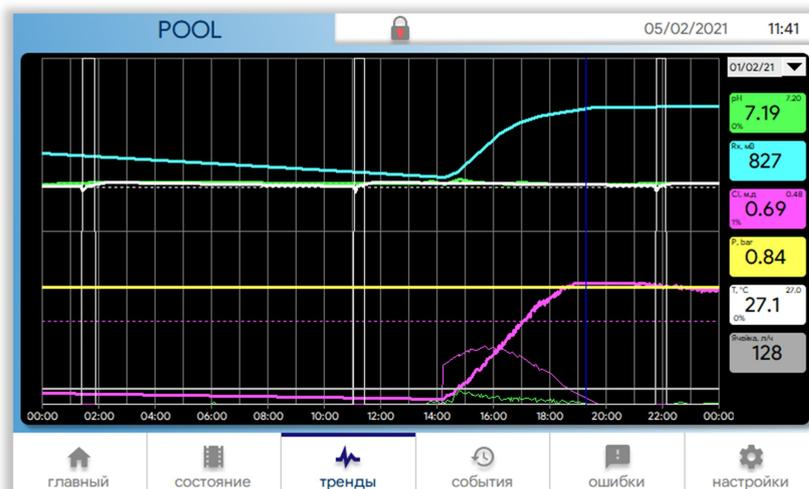
Тонкими штриховыми линиями отображаются уставки параметров. Тонкими сплошными линиями отображаются производительности насосов-дозаторов и процент открытия клапана теплоносителя. Широкими сплошными линиями отображаются значения параметров (рН, ОВП, свободный хлор, давление, температура, проток через измерительную ячейку).
