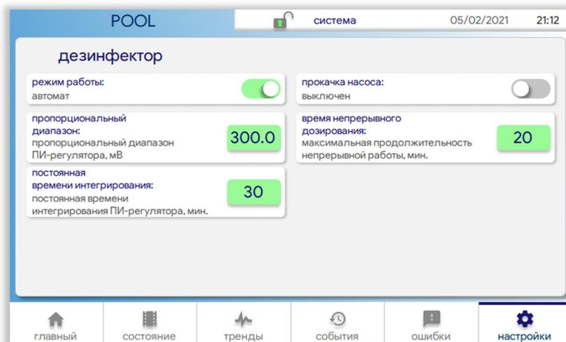
"режим работы" — выбор режима работы контура дезинфектора. В режиме "выключен" работа насоса-дозатора заблокирована. В режиме "автомат" работа насоса-дозатора осуществляется в автоматическом режиме.
