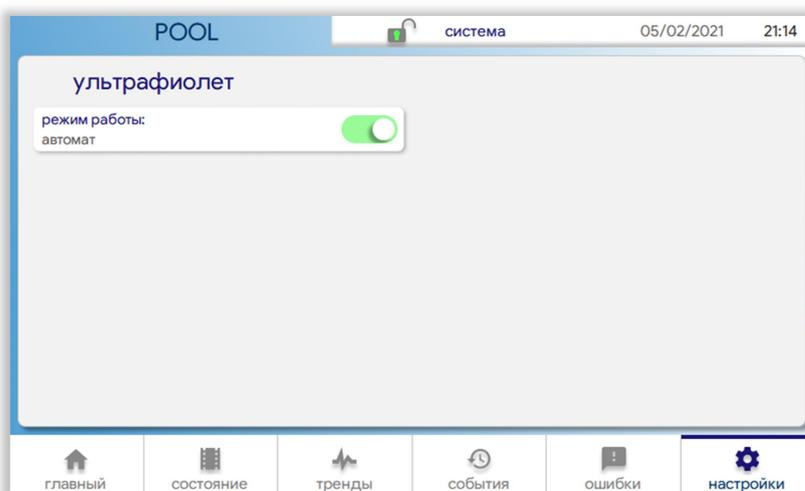
"режим работы" — выбор режима работы установки УФ-обеззараживания. В режиме "выключен" работа установки заблокирована. В режиме "автомат" включение/отключение установки производится в автоматическом режиме.
