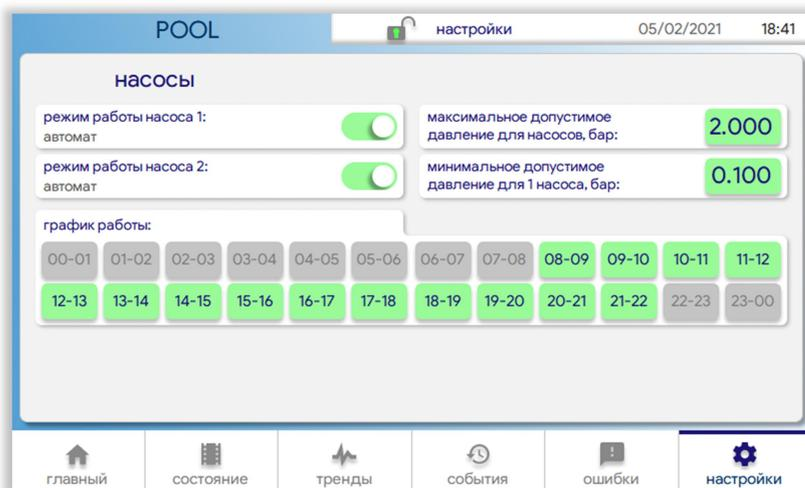
"режим работы насоса 1/2" — выбор режима работы насоса. В режиме "выключен" работа насоса заблокирована. В режиме "автомат" насос работает в автоматическом режиме. При наличии в системе двух насосов, один будет рабочим, второй - резервным. При каждом запуске системой выбирается насос с наименьшим моторесурсом. Для избежания "закисания" вала двигателя, при непрерывной работе в течении 84 часов происходит принудительная смена рабочего насоса.
