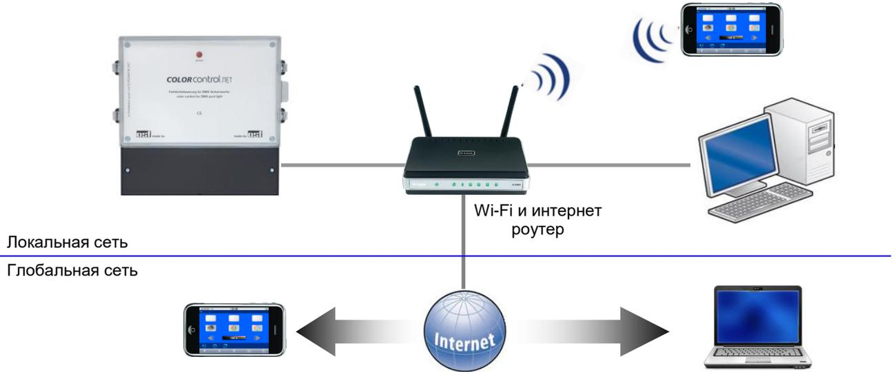
Для соединений необходимо использовать стандартный Ethernet сетевой кабель. Имеющееся соединение позволяет получить удаленный доступ к устройству в рамках локальной сети (смотри рисунок выше).
