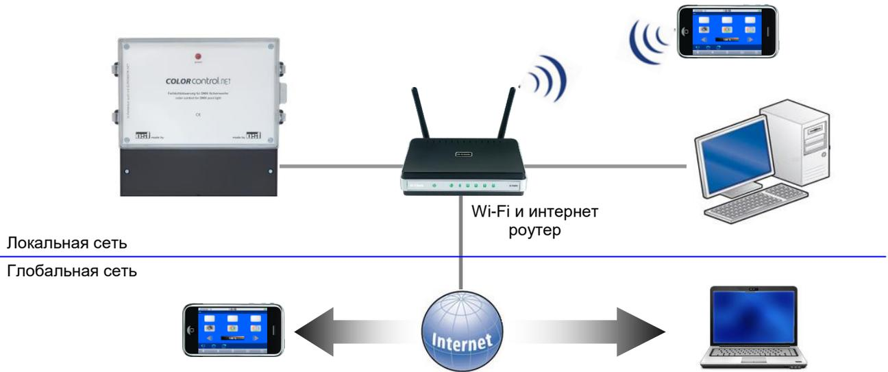
Для соединений необходимо использовать стандартный Ethernet сетевой кабель. Имеющееся соединение позволяет получить удаленный доступ к устройству в рамках локальной сети (смотри рисунок выше).
