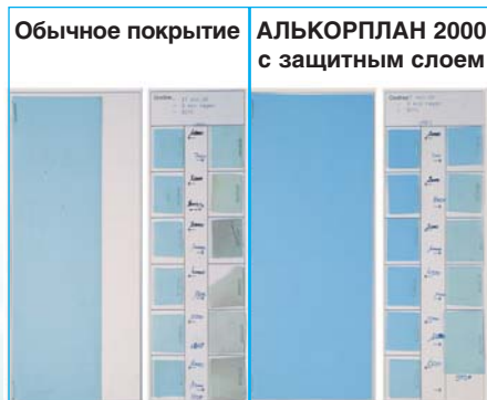
Результаты тестов Xenotest (воздействие света на материал в течение 10000 часов), что соответствует 10 годам нормальной эксплуатации покрытия, наглядно доказывают преимущества АЛЬКОРПЛАН 2000
